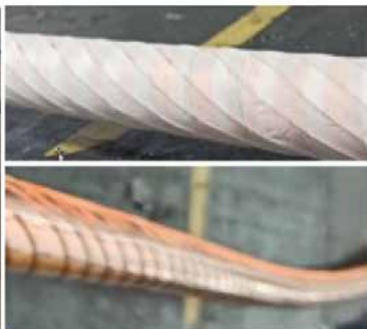
Verificação da integridade/ continuidade dos fios de blindagem após dobramento
